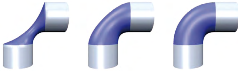
Fig. 25 - Esempi di "superficie più liscia possibile" definiti rispettivamente con le equazioni (1), (2) e (3).
